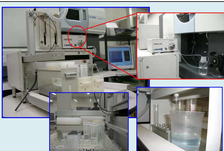
自動固相抽出ユニットとICP/OESへのオンライン接続
