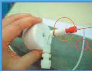
GLS ネブライザー/HPLC接続ユニット
