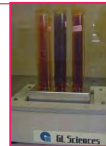
硝酸揮発除去 硫酸白煙温度にて硝酸を完全除去
