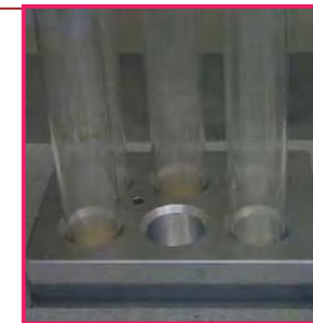
硫酸濃縮行程の様子 硝酸を完全除去後、余分な硫酸を除去
