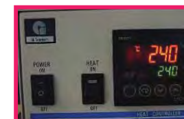
硝酸揮発除去 硫酸白煙温度にて硝酸を完全除去
