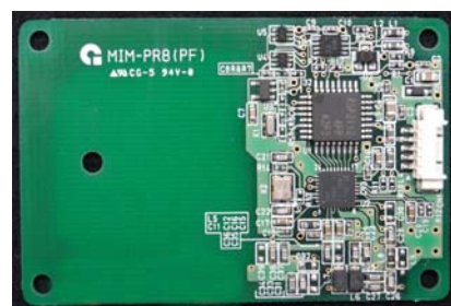
ISO-14443 系と ISO-15693 系を 同時利用できる TM02-C-5V
