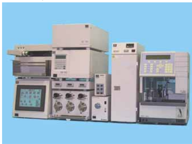
トランスPCB用自動クリーンアップ装置 PAC 795
