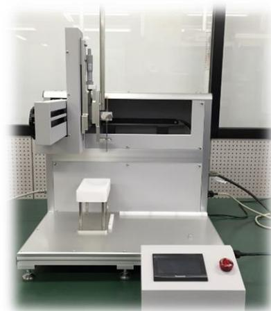
タンパク質など生体試料の解析では、試料量が少ない場合が多く、クロマトグラフを用いた分画・精製においては流量が低く一般的なフラクションコレクターではうまく分画ができないことがあります。本装置を用いると回収チューブの液面までプローブを下げることができ、少量の試料でも効率的に分画することができます。プロテオミクスにおける2次元クロマトグラフのフラクションに最適です。
