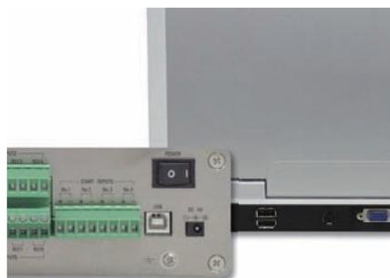
接続キットとコンピュータとの接続は、パソコンに用意されている USB ポート (1.1/2.0/3.0) を使用します。また、AD430 は小型 (200 (W) × 172 (D) × 65 (H) mm) で縦置きや横置きどちらでも可能です。
