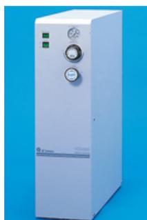
ニトロミニNM910は、有機不純物(VOC、SVOC)濃度を高純度窒素ガスボンベ並みに抑えた、有機溶媒をパージするのに最適な装置です。装置の幅は、200 mmとスリムであり、また、各種溶媒回収装置と組み合わせることにより、実験机上にコンパクトな窒素パージ式高速溶媒蒸発、濃縮、乾固システムを構築できます。また、窒素ガスを利用するリアクティブアップ、リアクティサーモのガス供給源として便利です。
